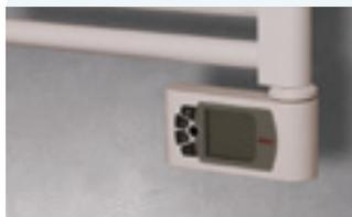
Resistenza elettrica ad innesto tramite fastom con controllo elettronico per regolare la temperatura ambiente, programmabile settimanalmente. Classe di isolamento II. Grado di protezione IP44. L'elettronica è fornita in colore Bianco Standard (cod. 01) per radiatori bianchi; cromata per radiatori colorati.
